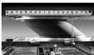
実大免震装置を用いた大変形性能試験の様子
