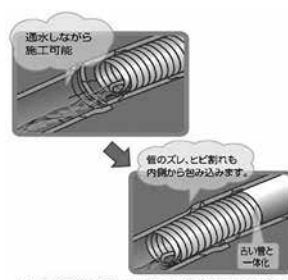
SPR工法が内側をスパイラル状に包んでいく！ 管路更生SPR工法
