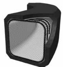
フローリング工法による矩形断面の更生例
