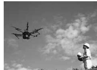
UAV (ドローン) レーザスキャナ測量
